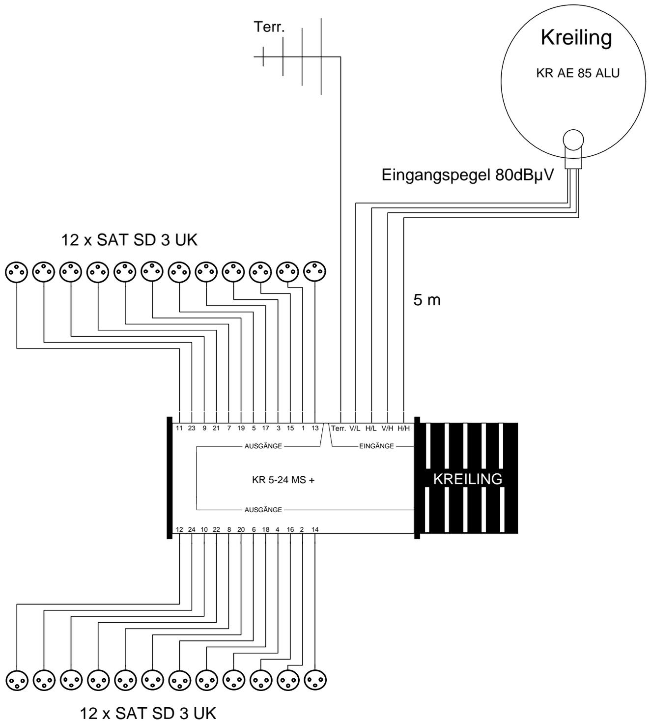
Teilnehmeranschlußlängen von 5 - 60 Meter bei Verwendung von Bedea Telass 110 möglich.
