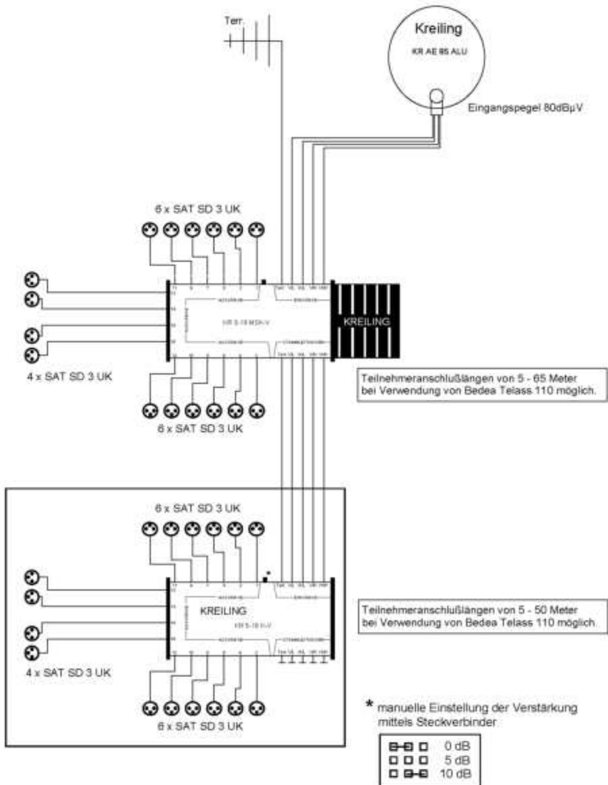
**Achtung!** Verwenden Sie nur gleichspannungsentkoppelte Abschlusswiderstände 75 Ohm zum Abschließen nicht benutzter HF- Ein und Ausgänge bzw. Stammleitungen.
